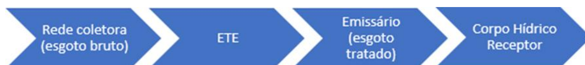
Figura 32 – Fluxograma representativo dos componentes do SES Primavera.
