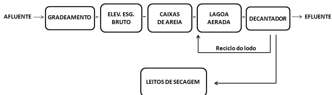
Figura 26 – Fluxograma operacional do sistema de tratamento da ETE Parque Marinha.
