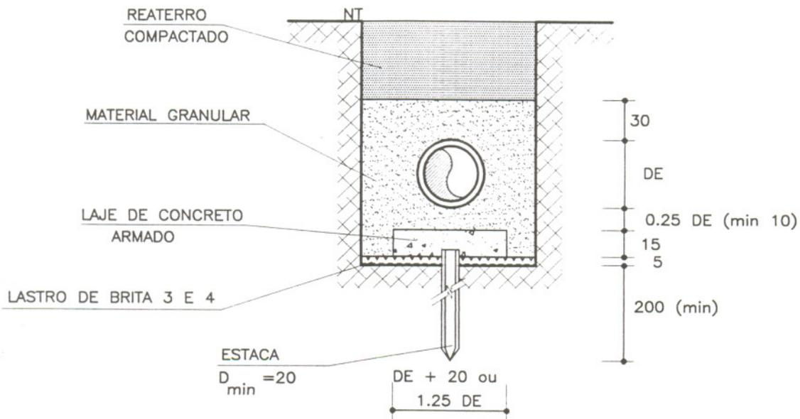
TIPO TV20 : APOIO SOBRE BERÇO CONTÍNUO DE CONCRETO COM ENROCAMENTO
