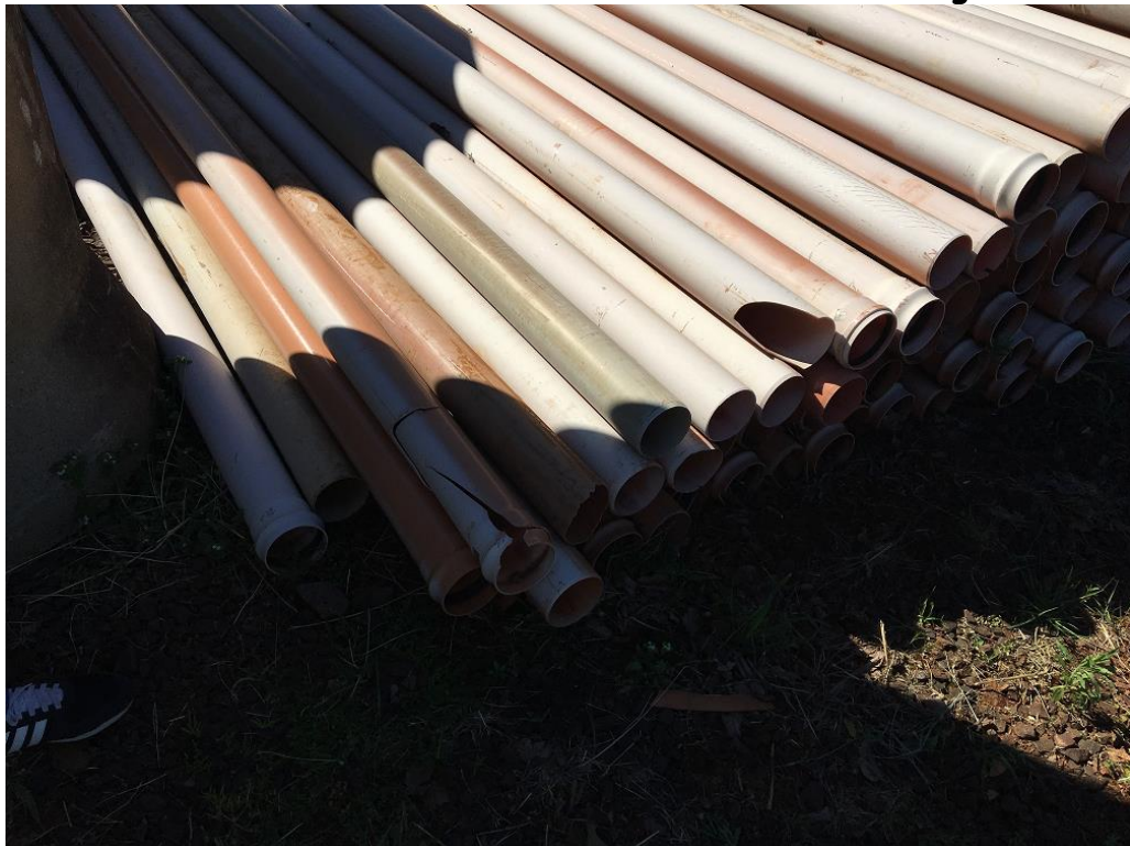
Foto 3 - Tubo de PVC JEI/JERI DN 100 Coletor de Esgoto
