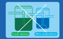
IMPORTANTE: nunca ligue o escoamento da água da chuva (rede pluvial) à rede da Corsan (cloacal), pois ela foi projetada apenas para receber o esgoto sanitário. Essa ligação indevida pode provocar transbordamento, tanto na via pública quanto dentro do seu imóvel.
